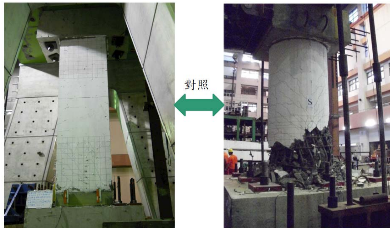
圖 10-6 卸震鋼甲國家地震工程研究中心試驗結果照片
